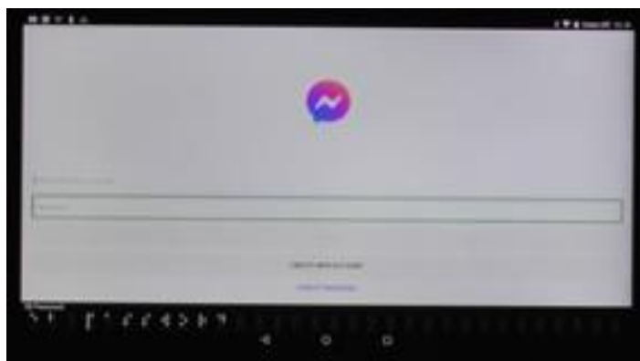
Fig. 12: Messenger på BrailleSense Polaris. Den grønne firkant rundt om det nederste felt, hvor der står ”Password”, illustrerer, at det er det felt, Michael læser på sin Polaris. Man kan imidlertid se, at cursoren er hoppet op i det øverste felt, hvor der står ”Phone Number or Email”. Cursoren følger således ikke det felt, som Michael læser og ønsker at skrive i.
